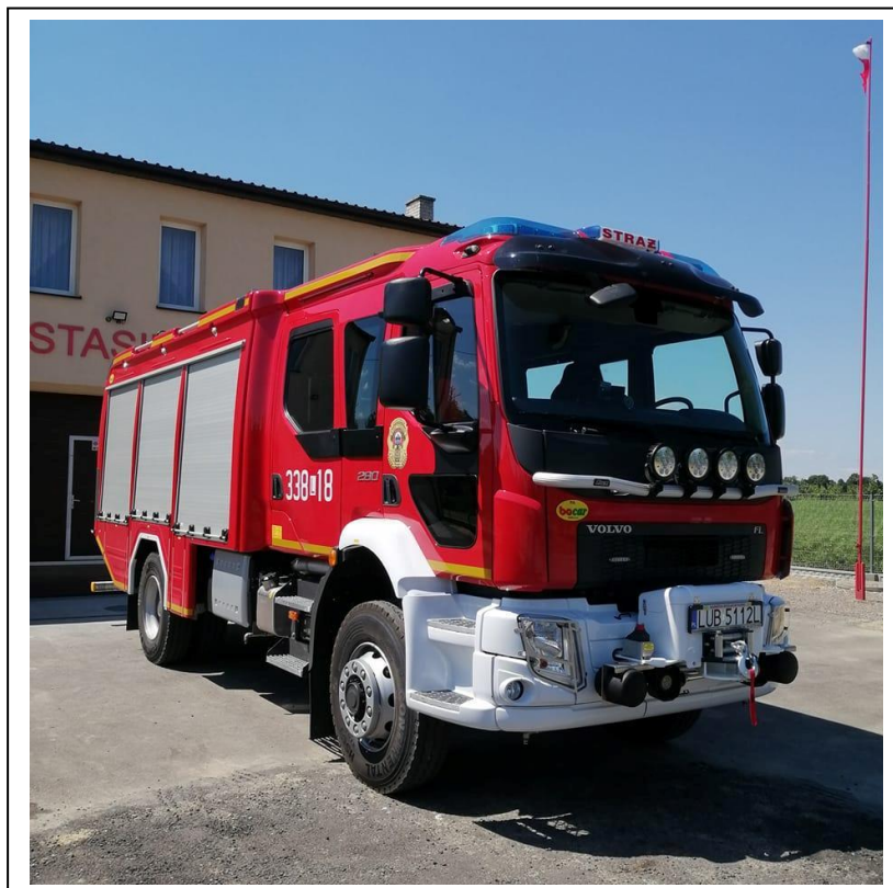
Fot. 72. Nowy średni pojazd ratowniczo-gaśniczy Volvo FLD3C FL GBA-Rt 3,2/16 - OSP Stasin.
